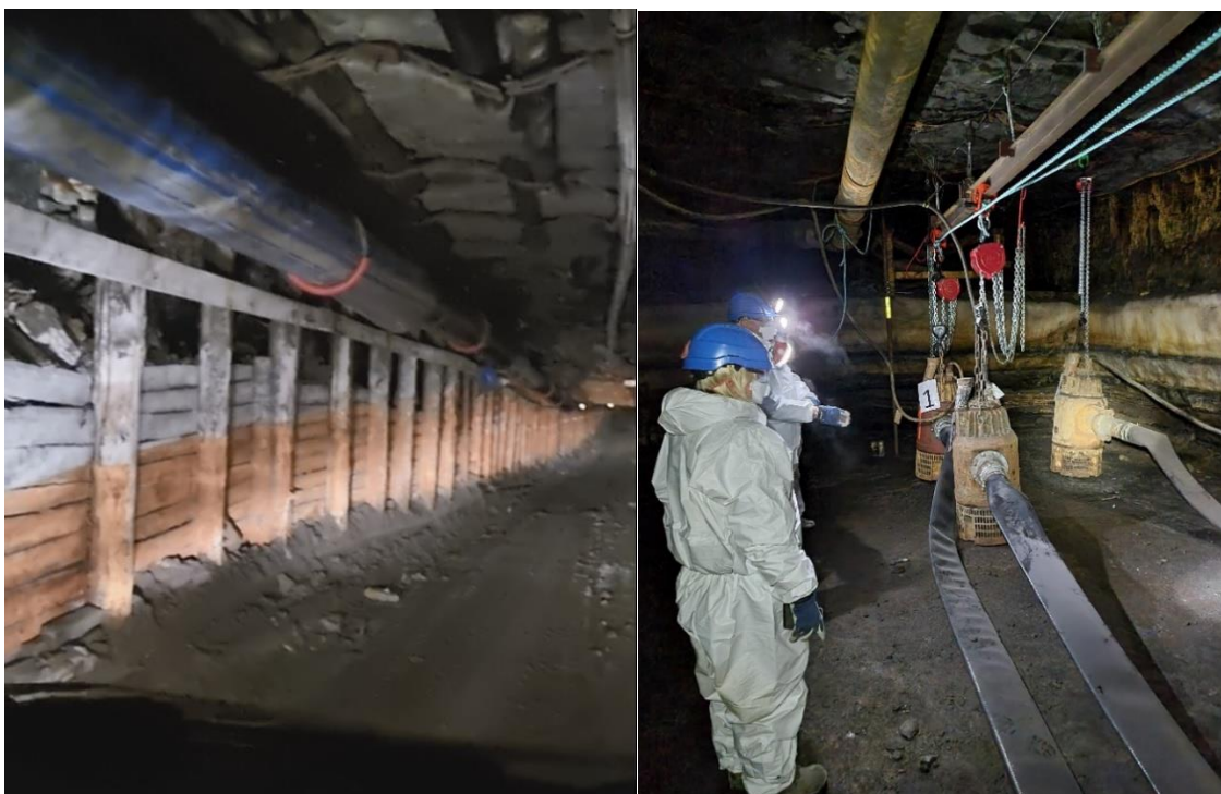
Gruve 7. Bildet til venstre: det brune feltet på vegg og i tak viser at vannet fylte gruve med vann til taket sommeren 2020. Bildet til høyre: Nye pumper som er installert i Gruve 7 i etterkant av vanninntrengingen. Fotos: Riksrevisjonen 2021.
